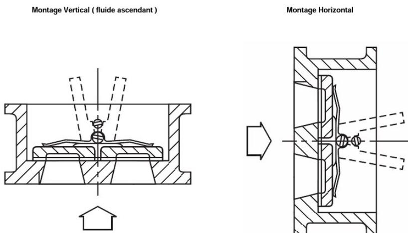
Positionner l'axe du clapet de manière verticale pour que le fluide exerce la même pression sur les 2 battants
